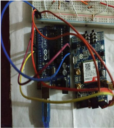
(a) GSM module (SIM808) circuit
